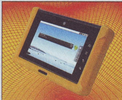
eMMC Flash und 512 MByte SDRAM. Die dauerhafte Speicherung der Daten erfolgt auf einer Solid State Disk. Für den drahtlosen Datenaustausch bietet der Tablet-PC ein schnelles 802.11-b/g/n-Modul, ein 3.5G-HSUPA-
